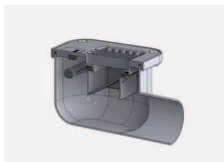
En position de repos, un contrepoids pousse la vanne d'obturation contre la surface d'étanchéité.
