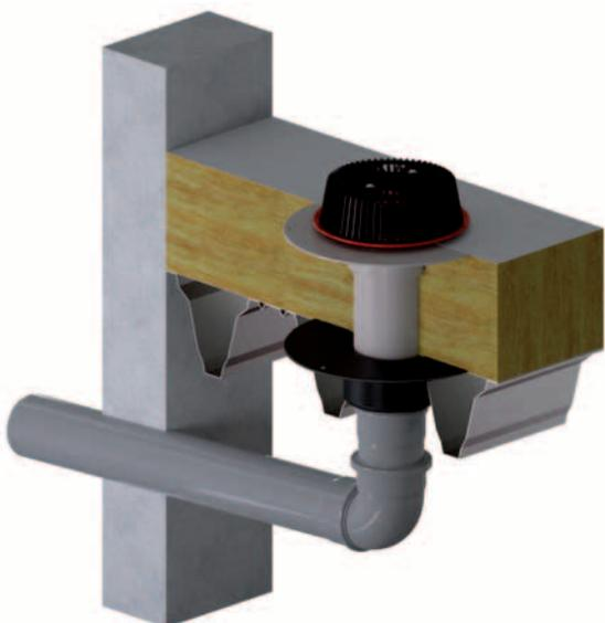
Situation de montage : unité de drainage de secours 86.1 avec avaloirs de toit 62 et éléments pour rehausser 630, pour isolations thermiques de 50 à 250 mm
