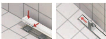
Installation du cache verrouillable
